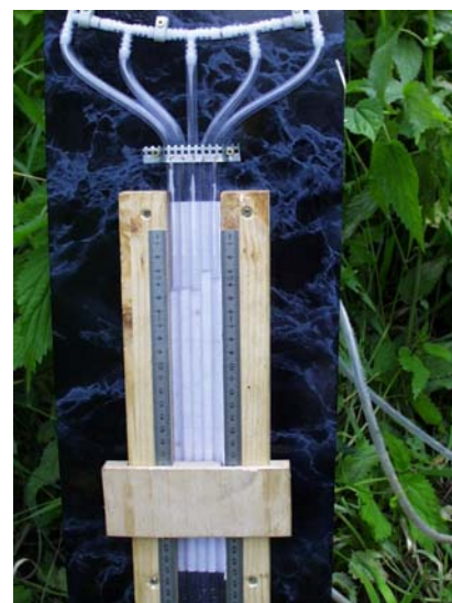
Abb. 20: Messprinzip und Abbildung des Piezometers (5fach-Anbindung) zur Bestimmung von Differenzdruckhöhen
