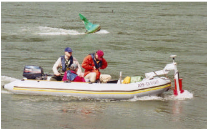
Abbildung 22: ADCP Messgerät am Geräteträger
