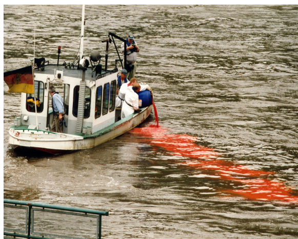
Obr. 3.1: Vypuštění značkovací látky do Labe
