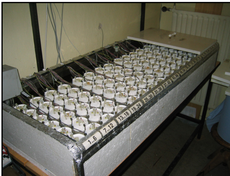
Abb. 4: Respirocondanlage der Firma Nordgreen Innovations zur Messung der CO 2 -Freisetzung
