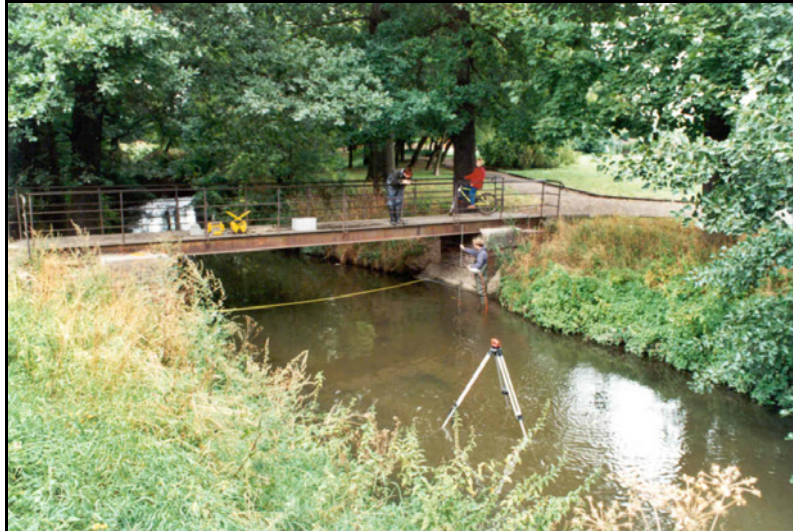
Abb. 6-2: Feststofftransportmessung am Bsp. der Döllnitz / Ms Riesa-Merzdorf (Messung der Fließgeschwindigkeit mit Nautilus C 2000, Nivelliergerät / Bodengreifer, Horizontalschöpfer auf der Brücke).
