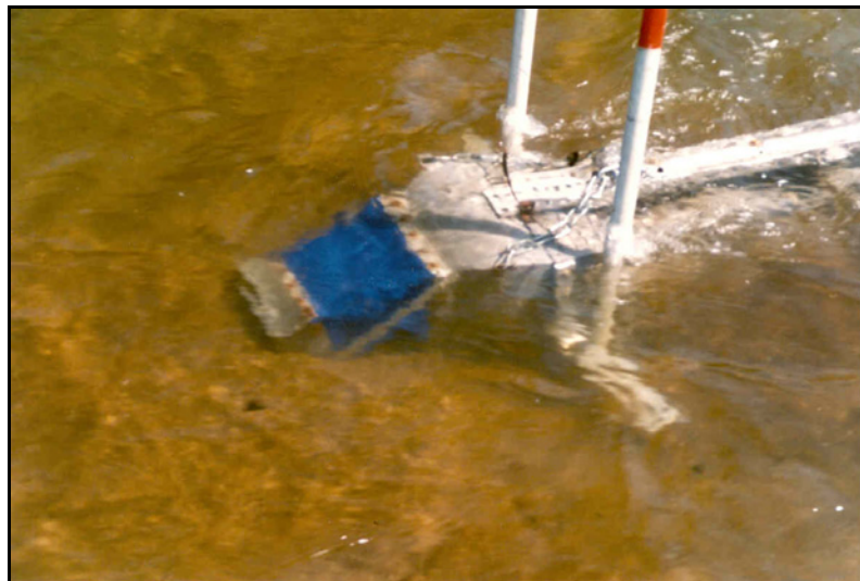
Abb. 6-3: Umgebauter BfG-Geschiebefänger während der Geschiebemessung (Bsp. Lachsbach, Messprofil 100 m vor der Mündung)
