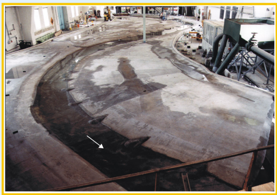
Hydraulisches Modell "Mockritz Döbern" El-km 160,0 - 164,0 (Erosionsstrecke)
