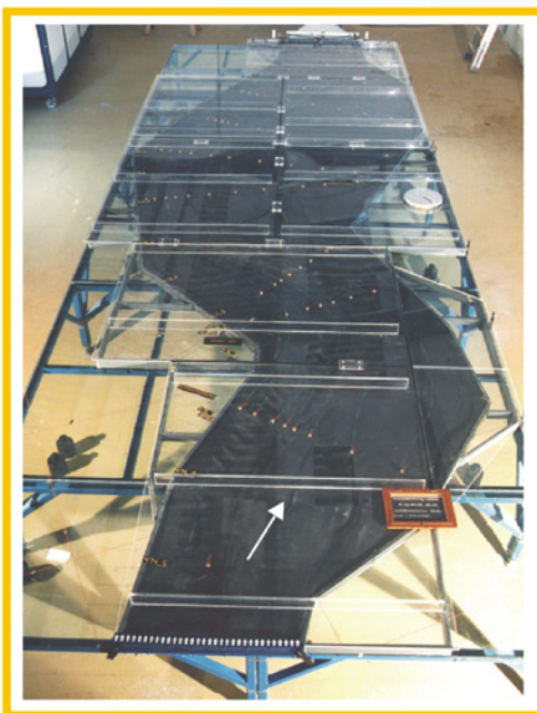
Aerodynamische Modell (Luftmodell) "Lenzen" El-km 474,2 - 484,1
