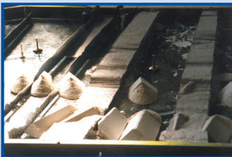
Modellierung der Geländetopographie: Ausgießen der Geometriestreifen mit Formgips zwischen Querprofillehren, Bühnen als separate Gipsformen ausgeführt.
