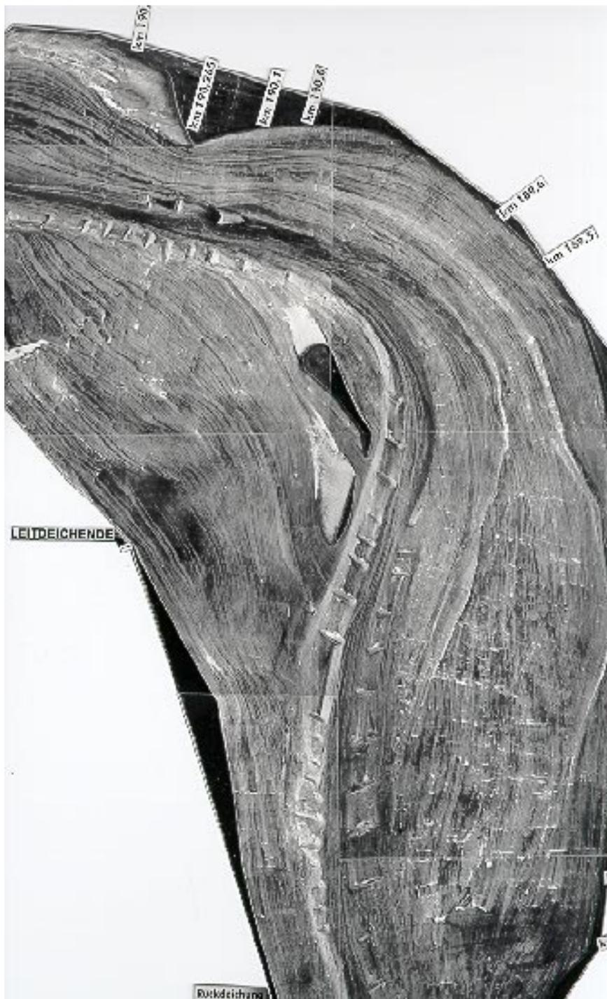
**Abb. 6.3:** Sichtbarmachung der Sohlstromlinien mit Anstrichverfahren für Variante 1A (Deichrückverlegung)
