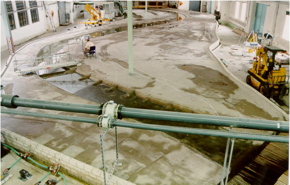
Abb. 7.4: Blick auf das fertige Modell in Fließrichtung bei  $Q = 183 \text{ m}^3/\text{s}$
