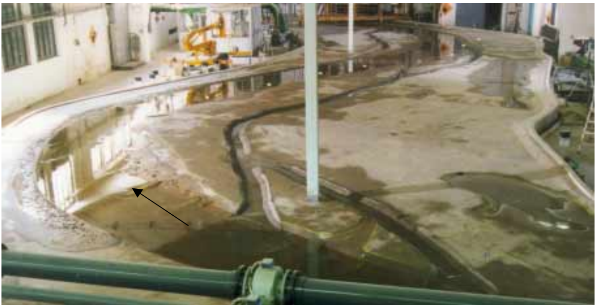
Abb. 8.1: Hydraulisches Modell mit eingebauten Flutrinnen
