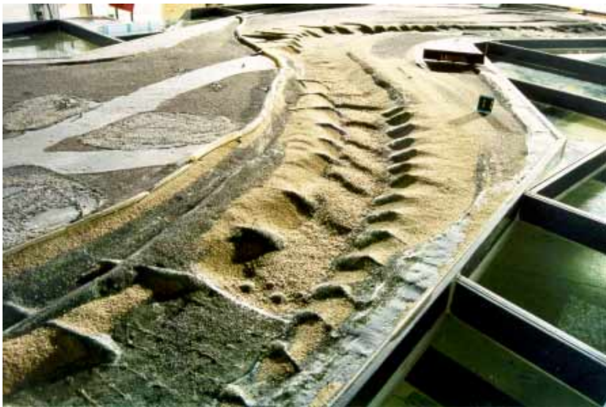
Abb. 7.11: Sohle des Geschiebekoffers nach dem Langzeitversuch für den Nullzustand
