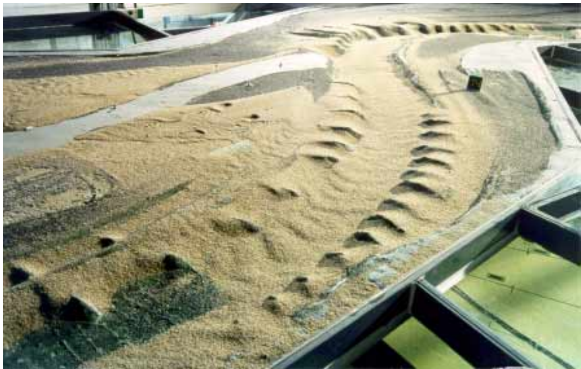
Abb. 7.13: Sohle des Geschiebekoffers nach dem Versuch ohne Deich
