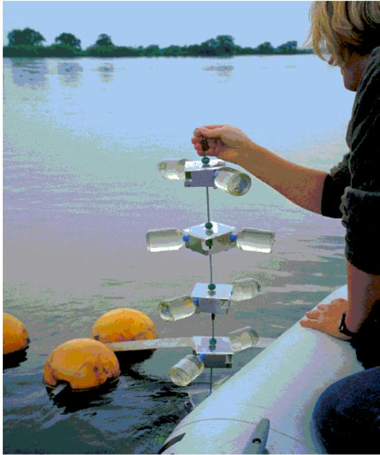
**Abb. 18: Ermittlung der Tiefenverteilung der planktischen Primärproduktion (Winklermethode)**
