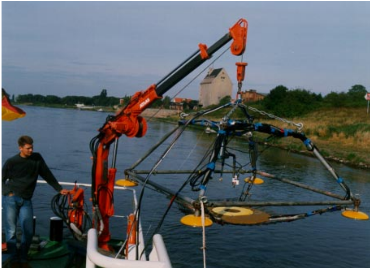
Abb. 3: Einsatz der Schubspannungsmesseinrichtung bei Wittenberg
