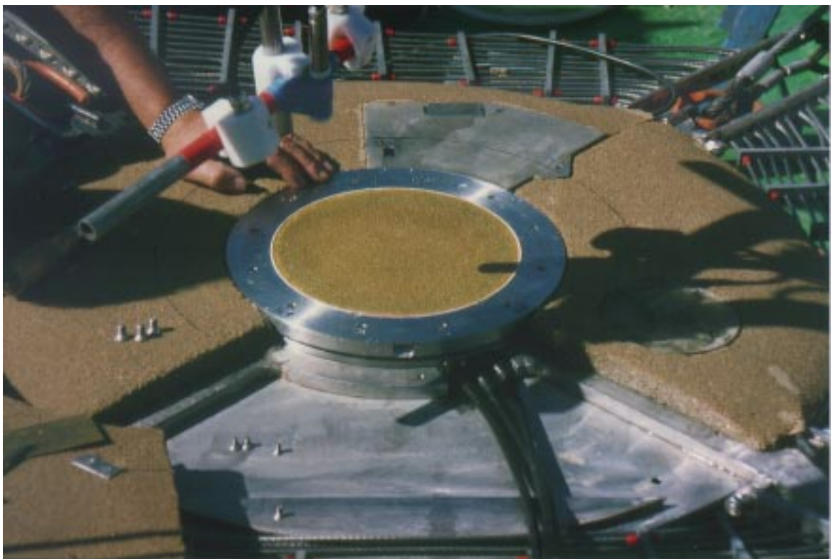
Schubspannungsmesssystem: Linsenförmige Geräteeinfassung (teilweise demontiert) und die im Edelstahlgehäuse bewegliche Messplatte (unteres Bild, Bildmitte) mit definierter Rauigkeit an der Oberfläche
