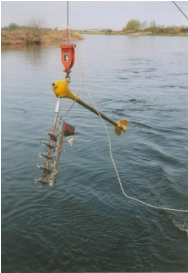
Abb. 1: Einsatz der Kleinflügelmesseinrichtung an der Messstelle Mühlberg
