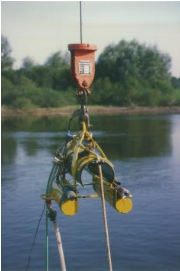
Abb.2: Einsatz der Trübungsmess-einrichtung bei Belgern
