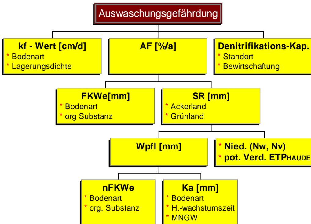
Abb. 5.61: Schematische Darstellung der Vorgehensweise zur Abschätzung der Nitratauswaschungsgefährdung
