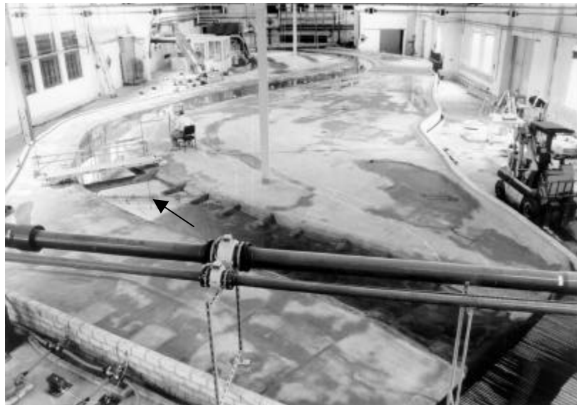
Abb.1: Blick in Fließrichtung auf das Modell bei Niedrigwasser, Q = 183 \text{ m}^3/\text{s}
